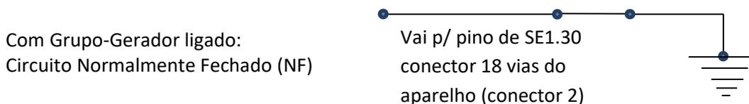
*Este pino **SE1.30** é multiplexado, quando esta função é habilitada, automaticamente as outras são desabilitadas: “Sensor de proteção Entrada E1”, “Sinal de Entrada Auxiliar” e “Lig/Des.GERADOR por botão à distância”.*
